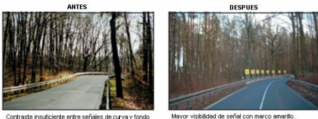
Figura 2.7 Mejoramiento del contraste de señales viales
