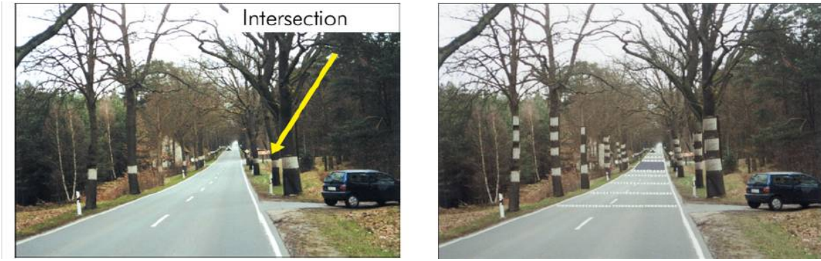
Figura 2.13 Ejemplo de reducción de distancias focales (Izq. antes – Der. después)
